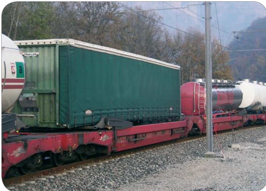
Ejemplo de semiremolque de lona rebajada utilizada en la autopista ferroviaria alpina.
