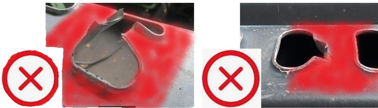
Fig 5. Agujeros para el paso del gancho fisurados con uso prohibido
