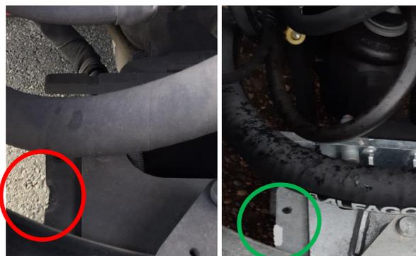
Fig. 1B: lanza deformada - lanza reparada pintada
