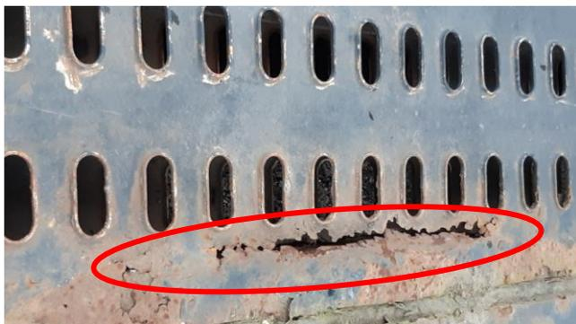
Figura 1A: oxidación atraviesa la plataforma
