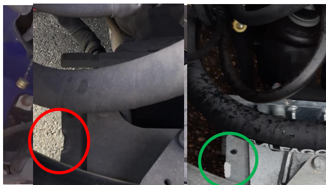
Fig 1B : timon déformée - timon réparé repeint
