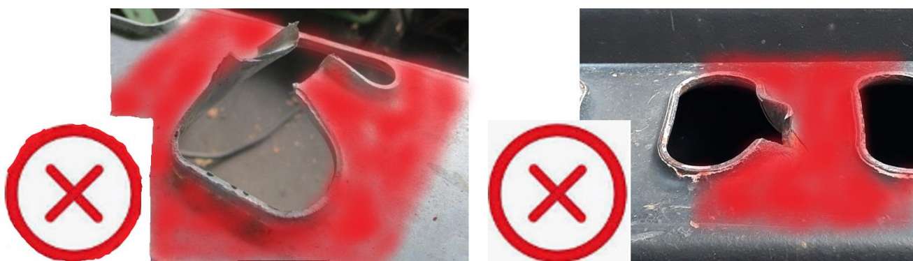
Fig 5. Trous de passage de crochet fissurés interdits pour arrimage
