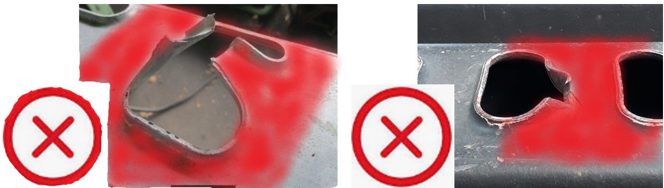
Abb 5. Gerissene Befestigungspunkte - Befestigung verboten
